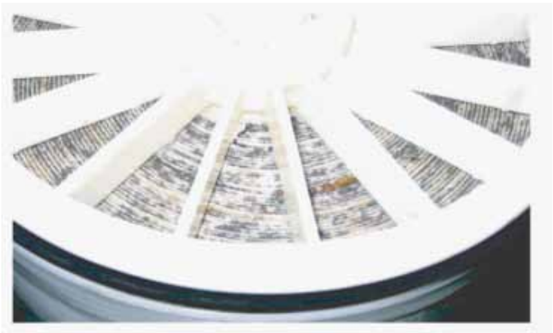
图7-17颗粒物污堵的膜元件端面图
