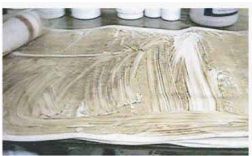
图7-18受悬浮物污染的膜元件端面图
