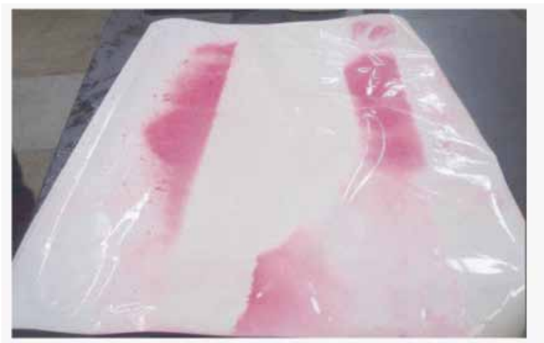
图7-16受到氧化的膜元件解剖图
