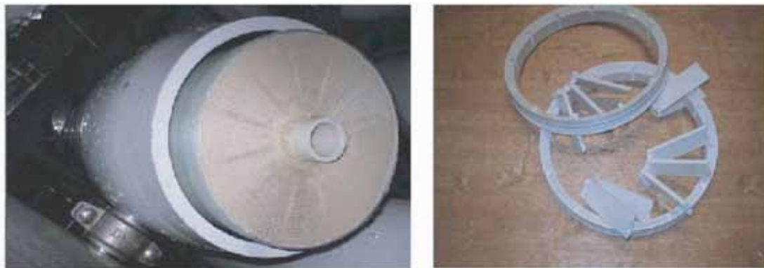
图 7-21 水锤导致膜的抗应力器损坏图
